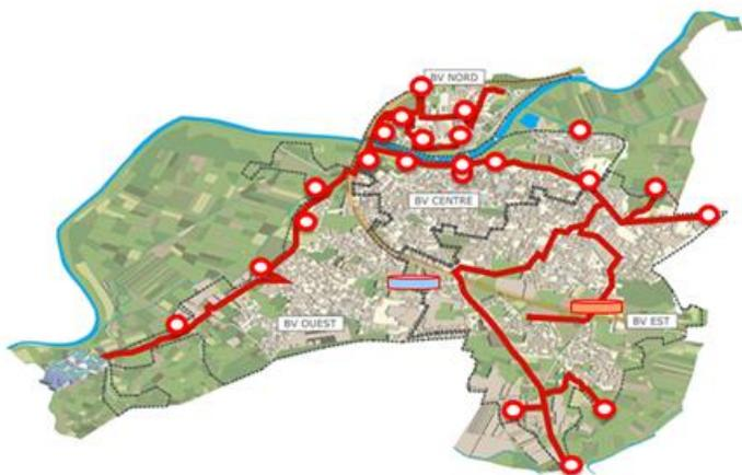
Ce réseau, mesurant aujourd'hui 203 km, collecte les eaux pluviales et les eaux usées domestiques qui sont transférées vers la station d'épuration (via un collecteur général équipé de postes de pompage, en point blanc sur la carte).
