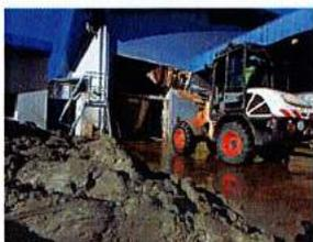
La préparation mécanique permet de transformer le limon (en le mélangeant à l'eau minérale) en une solution liquide permettant par la suite, grâce à une filtration, d'enlever tous les débris minéraux et organiques.
