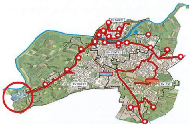
Ce réseau, mesurant aujourd'hui 203 km, collecte les eaux pluviales et les eaux usées domestiques qui sont transférées vers la station d'épuration (via un collecteur général équipé de postes de pompage, en point blanc sur la carte).
