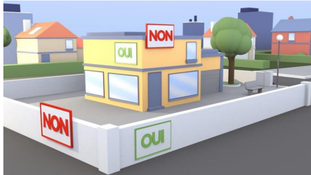
L'enseigne ne doit pas dépasser la limite du mur qui la supporte
